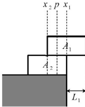
(4) 이 경우는  $A_1, \dots, A_{k-1}$  전체의 질량중심이 위 그림의  $x_1$ 에 위치하고 있는 경우이다. 따라서 탑 전체의 질량중심은  $x_1$ 과  $x_2$ 를 연결하는 선분을  $1:k-1$ 로 내분하는 점에 위치한다. 즉,  $x_1 - p = \frac{1}{k}$  이므로  $L_k = L_{k-1} + \frac{1}{k}$  이 된다.
